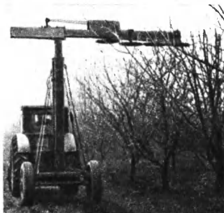
Контурная обрезка яблони при помощи машины.
